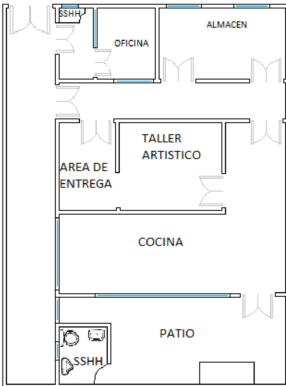
Figura 21. Distribución física de la pastelería. El establecimiento mide aproximadamente 12 metros de largo y 7 metros de ancho. El área mide 84 metros 2 .
